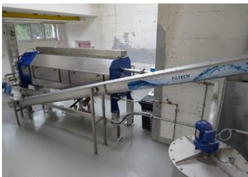
Abbildung 56: Beispiele einer Schneckenpresse zur stationären Klärschlammmentwässerung der Hersteller IEA (links) und Huber (rechts) (Quelle: IEA Derflinger und Huber SE)
