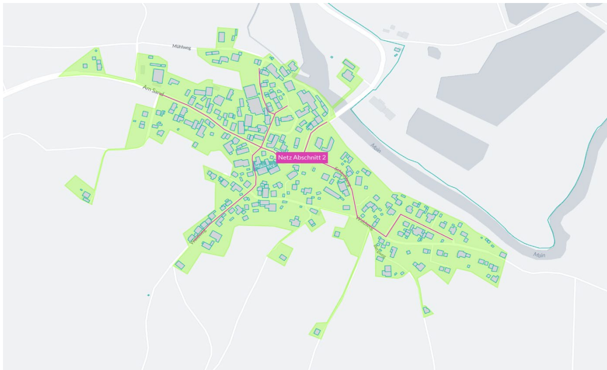
Abbildung 166: Konzeptvorschlag leitungsgebundene Wärmeversorgung | Prüfgebiet: Maineck
